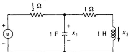
(a) Elija como variables de estado  $x_1, x_2$  la tensión en el capacitor y la corriente en la bobina, respectivamente, y muestre que la red se puede describir con las ecuaciones
