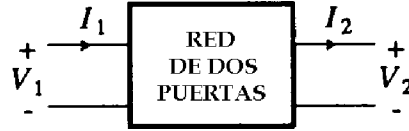
Figura 3.7: Red de dos puertos con la definición de los voltages y corrientes para la matriz cadena.
